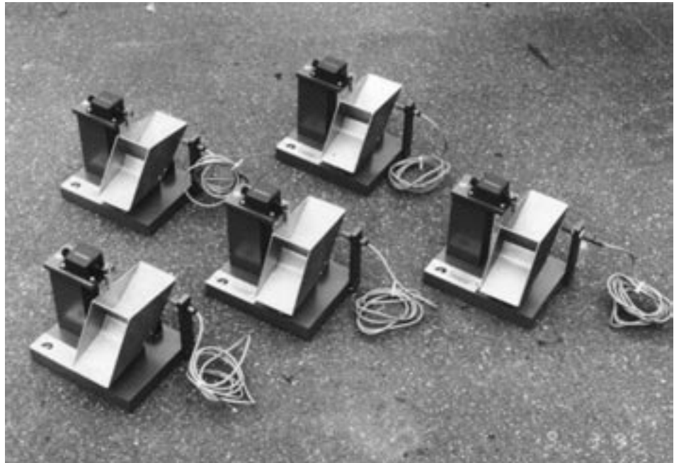
Fig. 2 : Godets à bascule (0,5 l double remplissage) avec compteur et contacteur magnétique pour raccordement sur unité de stockage.
