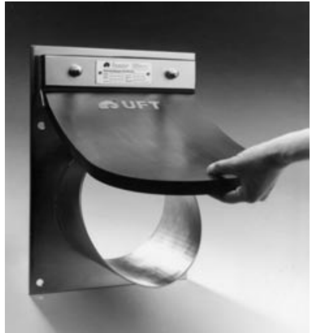
Fig. 2 : Le battant souple en caoutchouc se laisse décoller très facilement du bord fin de la tubulure elliptique et lors de reflux est parfaitement étanche.
